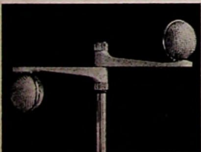
Op deze foto ziet u de armen waarmee de microfoons gericht kunnen worden.
