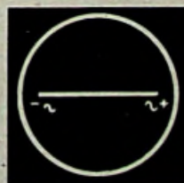
Fig. 5: wisselspanning op horizontale platen.
