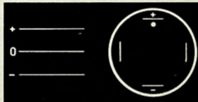
Fig. 3: gelijkspanning op de vertikale platen.
