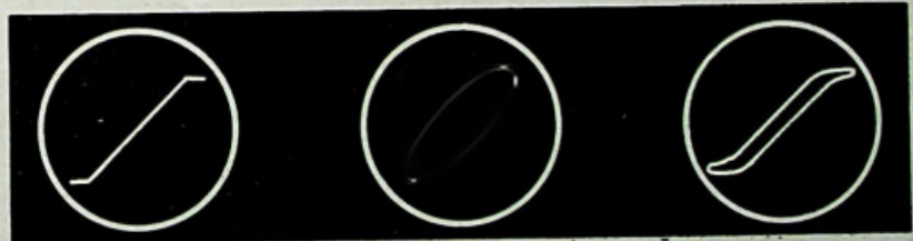
Fig. 14 Vervorming door oversturing al of niet gecombineerd m. faseverschuiving
