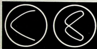
Fig. 22 Fig. 23 Frequentieverhouding 1 : 2, echter met een faseverschuiving van resp. 180^\circ en 135^\circ .
